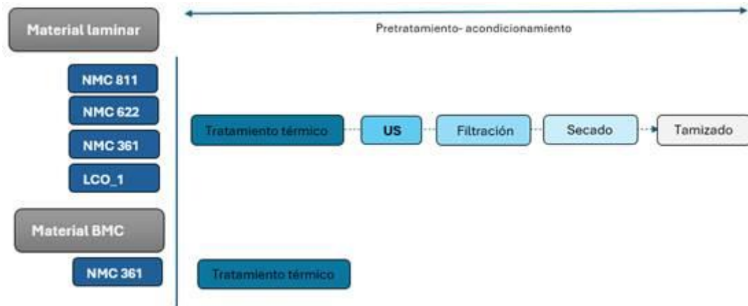
Figura 6. Esquema de tecnologías de pretratamiento aplicadas en función presentación del material. Figura 6 en el informe original, E4.1
