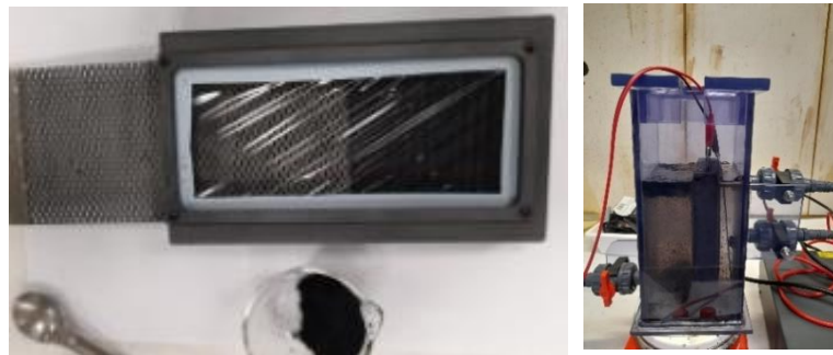
Figura 13. Preparación ensayo electrolixiviación en celda 1L. imagen durante ensayo electrolixiviación en celda 1L, etapa anódica
