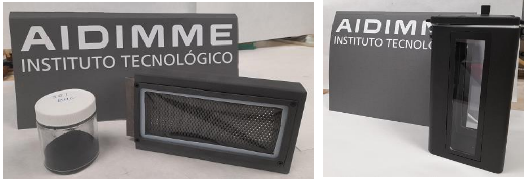
Figura 12. Marco y celda de electrolixiviación, capacidad 1 L fabricada en AIDIMME
