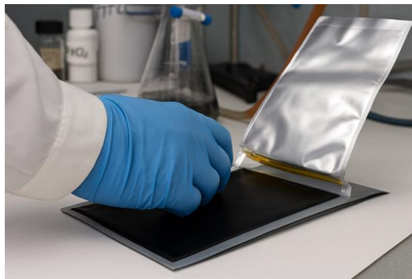
Figura 3. Apertura y retirada de la envolvente externa de la celda pouch .Ref. ITE
